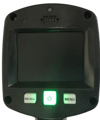
图 3.3b SVR3D 关机并充电时，开关按钮灯亮
